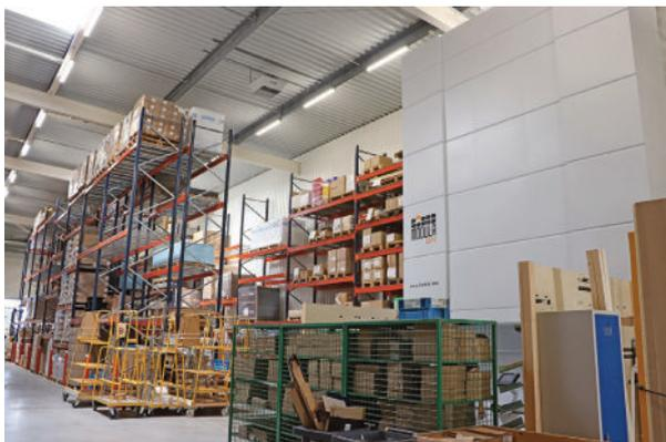
Ici sont stockés tous les éléments destinés au montage des menuiseries. Installé au printemps, Le Modula Lift stocke dans ses 57 tiroirs un grand nombre de références de pièces nécessaires aux ateliers des différents secteurs (montage). Il a permis de fiabiliser les stocks et de gagner du temps pour approvisionner les postes. L'opératrice scanne une série de références et la machine sélectionne les tiroirs. Le laser est une aide supplémentaire pour la guider en pointant la zone où chercher.
